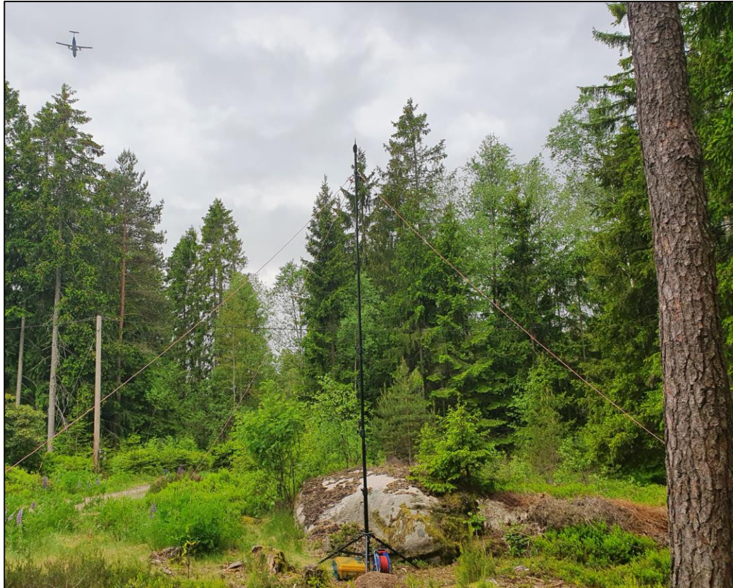
Figur 2. Bild på mätupställningen i Härryda bestående av mikrofon, stativ och övrig utrustning som hör till mätningen.
